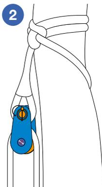
Refermer la flasque oscillante et l'axe haut, verrouiller avec la goupille de sécurité, vérifier que l'anneau est enclenché dans le cran de sureté (schéma 3).
