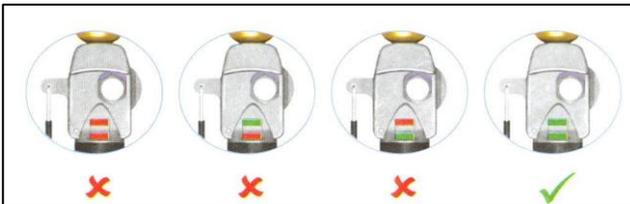
Wenn beide Indikatoren rot sind, muss der CO2-Gaszylinder durch einen neuen mit derselben Größe ersetzt werden. Die automatische Zündpatrone muss ebenfalls durch eine neue desselben United Moulders Dual Point Indikator-Typs ersetzt werden.
