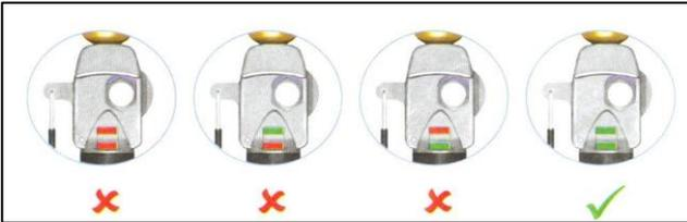
Se entrambi gli indicatori sono rossi, la bombola di Co2 deve essere sostituita con una delle stesse dimensioni. È necessario sostituire anche la cartuccia di attivazione automatica.
