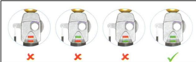
Ja abi indikatori ir sarkanā krāsā, CO2 gāzes balons jāaizstāj ar jaunu, kura izmēram ir jābūt vienādam. Automātiskās izšaušanas kasetne arī ir jāaizstāj ar....
