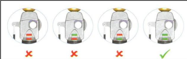
Če sta oba indikatorja rdeča, je treba plinsko jeklenko Co2 zamenjati z novim modelom enake velikosti. Prav tako je treba zamenjati kartušo za avtomatsko sproženje z novo kartušo z isto vrsto dvotočkovnega indikatorja United Moulders.
