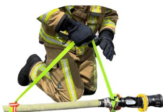
3. Serrer l'ensemble en vérifiant que la sangle soit bien sur le demi-raccord côté lance
