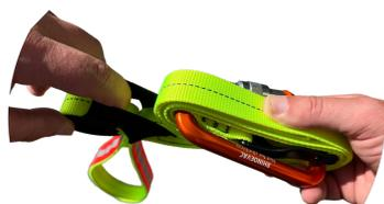
1. La came à griffe avec le mousqueton doit se retrouver près de la poignée traction n°2 (à l'opposée du pontet)
