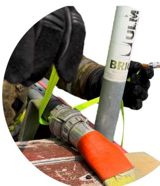
5. Continuer le serrage jusqu'à ce que le raccord soit bien plaqué sur le point fixe, visser la virole du mousqueton
