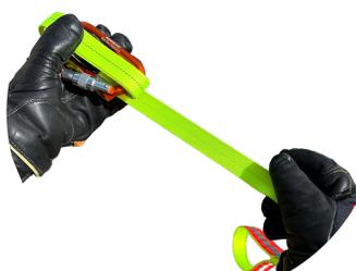
3. Pendant l'enroulement il n'est pas nécessaire de serrer à chaque tour cela se fera sur les derniers tours
