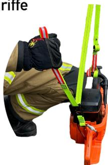
3. Si ce n'est pas possible en raison de l'épaisseur de la poignée de votre outil, insérer le mousqueton dans la poignée et connecter le mousqueton directement sur la sangle
