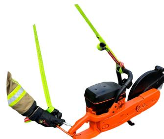
5. Lors du portage d'une découpeuse thermique ou tronçonneuse veillez à avoir le disque ou le guide toujours derrière vous
