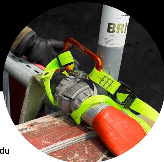
1. Positionner le raccord du tuyau prêt du point fixe
